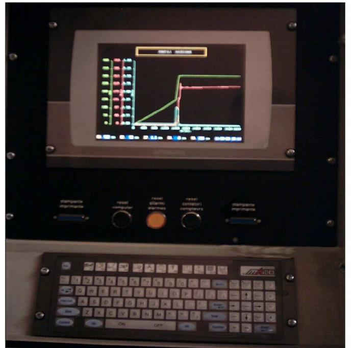
La lega di alluminio, allo stato fuso, viene iniettata nello stampo (pressofusione) con parametri di velocità e pressione coordinati ed assistiti da un PC. La pressione esercitata sull'alluminio può raggiungere i 1.000 bar/cm<sup>2</sup>. Ad ogni pezzo prodotto viene effettuato un controllo di qualità.
